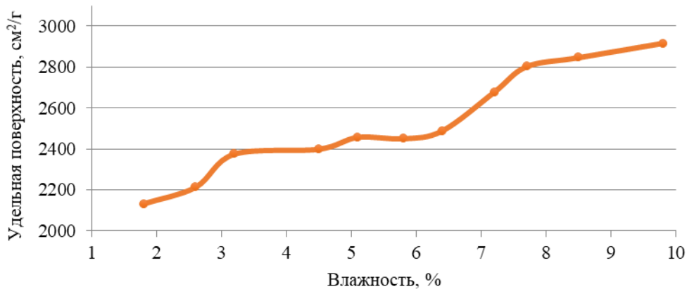
Рис. 1 – Зависимость удельной поверхности ПШ от исходной влажности кварцевого песка
