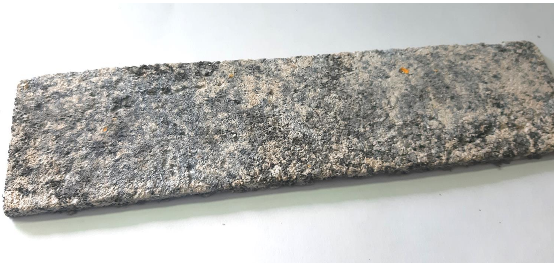
Рис. 4 – Внешний вид woodгипса окрашенного в массу с использованием колера черного и белого цвета
