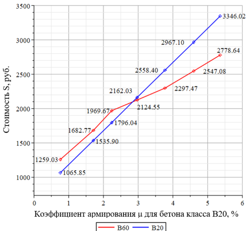
Рис. 4 – График зависимости стоимости 1п.м. балки от коэффициента армирования \mu для балки из бетона класса В20
