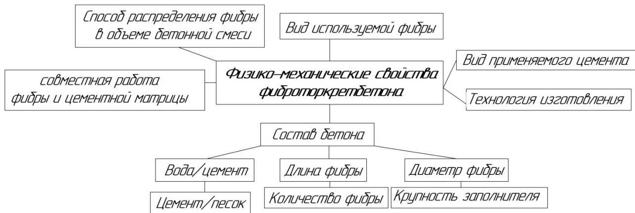
Рис.1 – Факторы, влияющие на физико-механические свойства фиброторкретбетона
