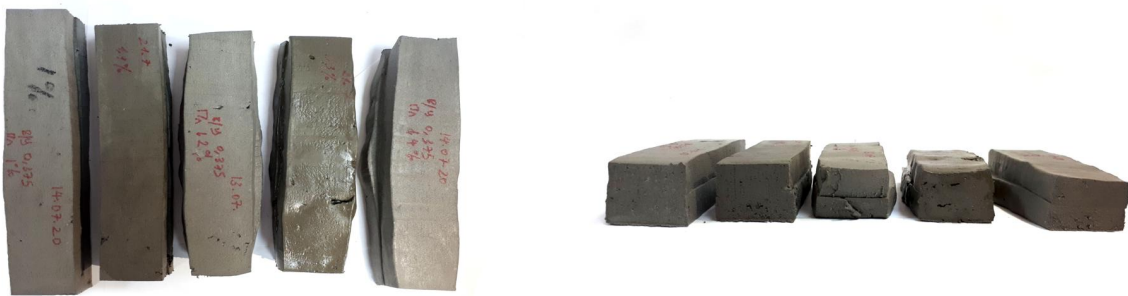
Рис. 5 – Деформации экструдированных слоев высокопрочного легкого бетона в горизонтальной (слева) и вертикальной (справа) плоскости
