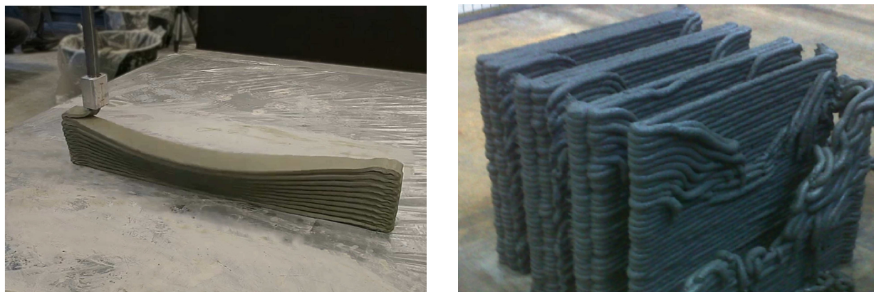
Рис. 2 – Пластическое разрушение конструкции при 3D-печати
