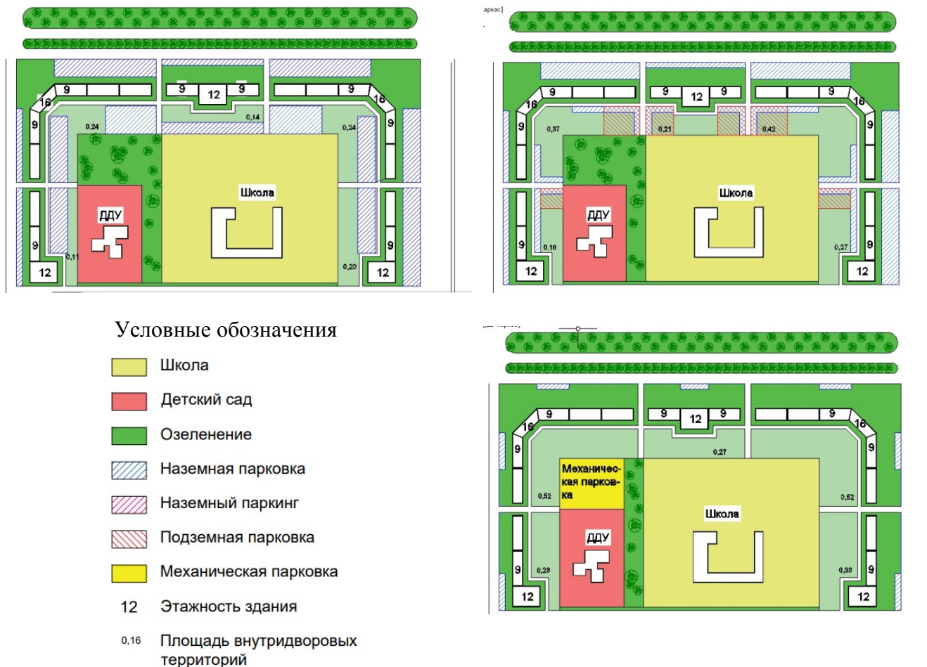
Рис. 1 - Варианты планировки квартала (микрорайона) с численностью населения – 2000 жителей: а) наземные парковки и автостоянки б) наземные и подземные парковки в) механические парковки
