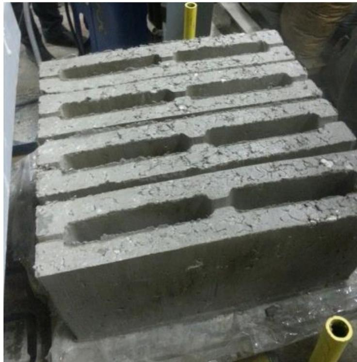
Рис. 5 - Фотография опытных прессованных образцов безобжигового ИПФМ
