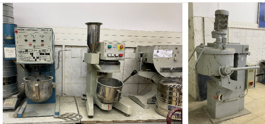
Рисунок 2 - Смесители германской фирмы «TESTING» емкостью 2 и 5 л, российской фирмы «НИКЦИМ Точмашприбор АЛС-5» емкостью 3 л DOI: https://doi.org/10.18454/mca.2023.42.1.5
