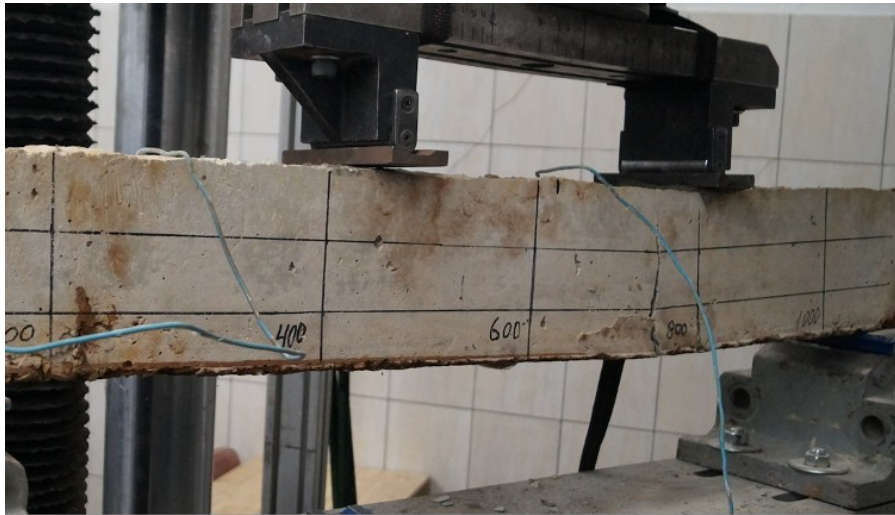
Рисунок 15 - Разрушение образцов DOI: https://doi.org/10.60797/mca.2026.69.12.16
