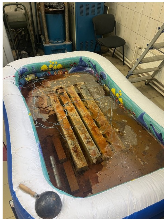
Рисунок 8 - Корродирование железобетонных образцов DOI: https://doi.org/10.60797/mca.2026.69.12.8
