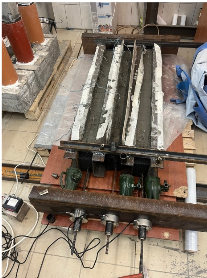
Рисунок 7 - Изготовление железобетонных балок-образцов DOI: https://doi.org/10.60797/mca.2026.69.12.7
