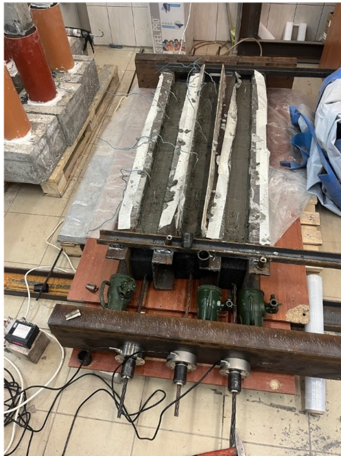
Рисунок 7 - Изготовление железобетонных балок-образцов DOI: https://doi.org/10.60797/mca.2026.69.12.7
