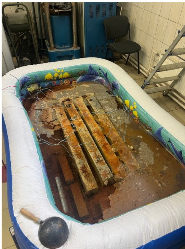
Рисунок 8 - Корродирование железобетонных образцов DOI: https://doi.org/10.60797/mca.2026.69.12.8
