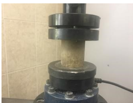
Рисунок 2 - Определение прочности при сжатии DOI: https://doi.org/10.60797/mca.2025.65.2.2
