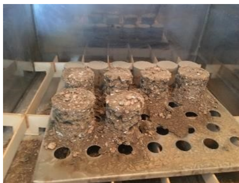
Рисунок 3 - Испытание образцов на морозостойкость DOI: https://doi.org/10.60797/mca.2025.65.2.8
