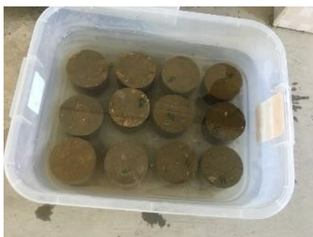
Рисунок 1 - Водонасыщение образцов DOI: https://doi.org/10.60797/mca.2025.65.2.1
