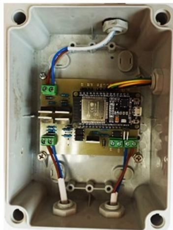
Рисунок 4 - Блок управления нагрузкой на узлы
