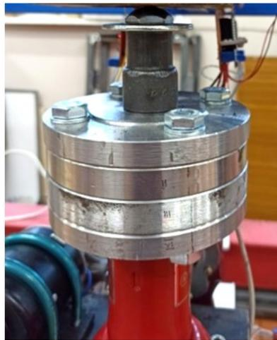
Рисунок 7 - Динамометр с электронным датчиком
