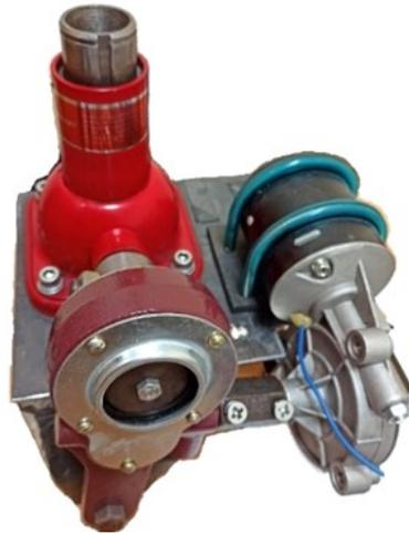
Рисунок 6 - Электромеханический домкрат
