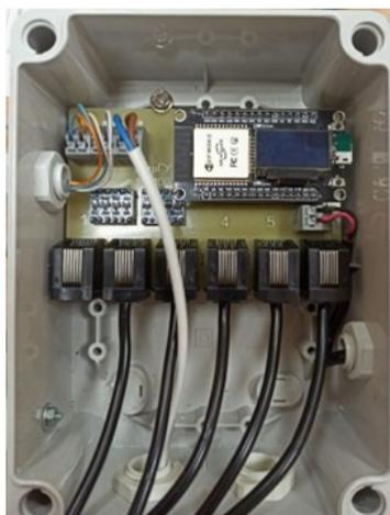
Рисунок 5 - Блок измерения продольных деформаций стержней
