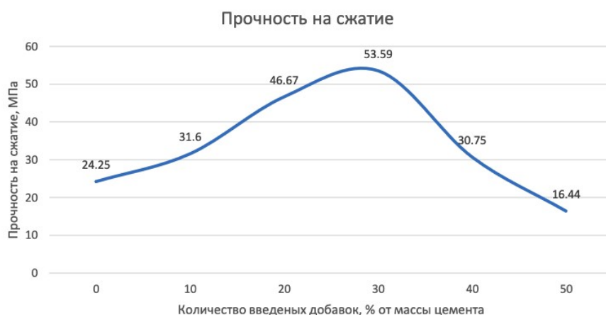
Рисунок 1 - Прочность бетона на сжатие DOI: https://doi.org/10.60797/mca.2026.72.1.1
