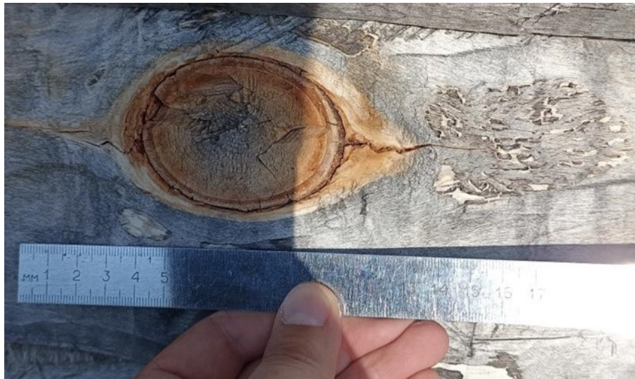
Рисунок 3 - Замер диаметра овального сучка DOI: https://doi.org/10.60797/mca.2026.71.1.3
