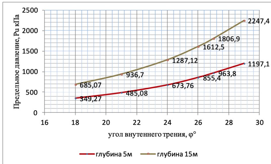
Рисунок 4 - Зависимость предельного давления P_u , кПа от угла внутреннего трения \phi супеси ( c=9-21 кПа; \phi=18-29 ; 0,25 < I_L < 0,75 ) на глубинах 5м и 15м
