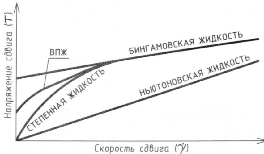
Рисунок 1 - Сравнение степенной модели жидкости, вязкопластической и Бингама
