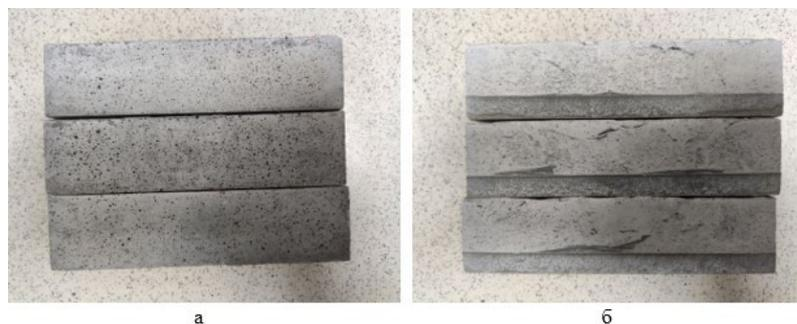
Рисунок 1 - Внешний вид образцов конструкционного легкого бетона с однородной (а) и расслоившейся (б) структурой
