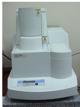
Fig. 2 – Thermogravimetric analyzer Shimadzu DTG-60 H
