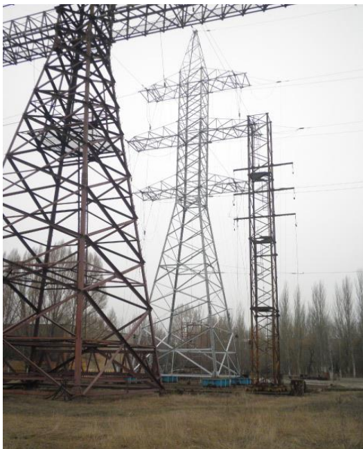
Рис. 4 – Общий вид испытываемой опоры У220-2+9 на Полигоне ДонНАСА
